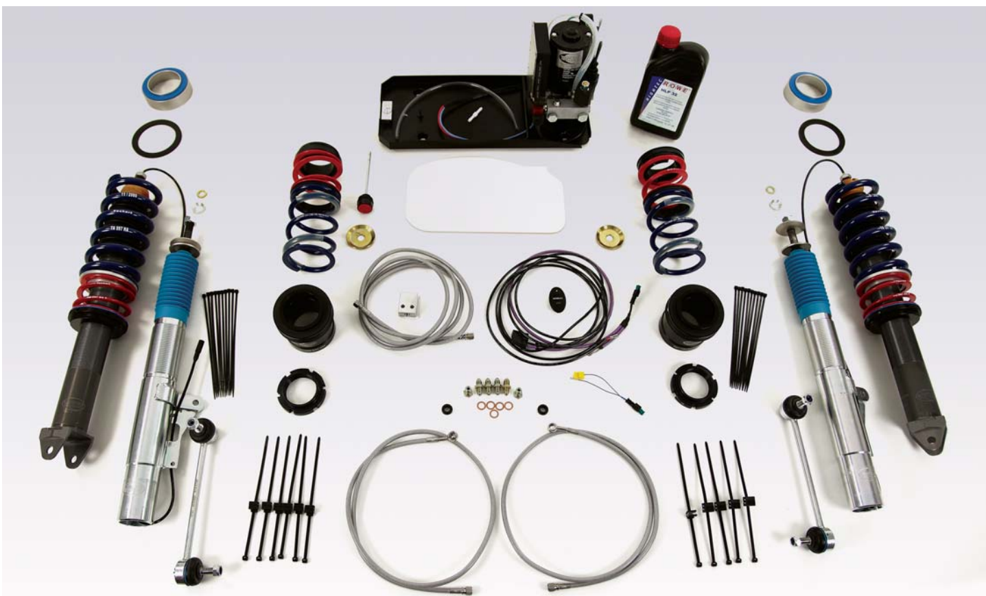
Der Teileumfang des TECHART Noselift System für die Porsche 911 (997) Modelle The TECHART Noselift parts kit for the Porsche 911 (997) models
