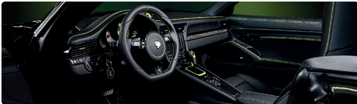
TECHART Interieur in schwarzem Leder mit Ziernähten in Acid Green, dazu passend lackierte Kunststoffteile sowie Zierleisten an Mittelkonsole, Instrumententafel und Türen in Carbon. TECHART interior in black leather with stitching in Acid green and color-matched plastic parts. Trims at doors, dashboard and center console in carbon fiber.
