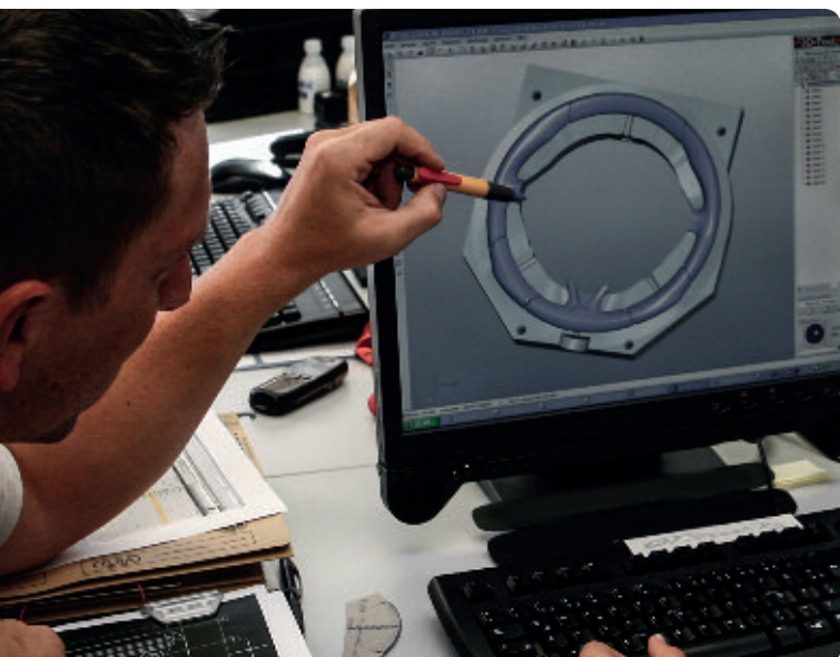
Konstruktion der Gusswerkzeuge für die ergonomisch geformten TECHART Sportlenkräder. Design of the casting molds for the ergonomically shaped TECHART sport steering wheels.
